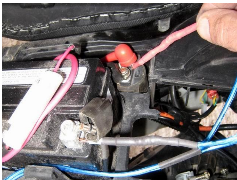
Pour démarrer on pointe simplement la fiche rouge sur le boulon cuivré du relais (borne en sortie de relais, reliée directement au démarreur)
