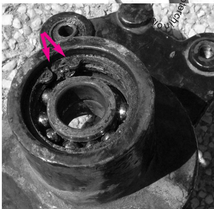
enlevez le circlip qui maintient les roulement en
